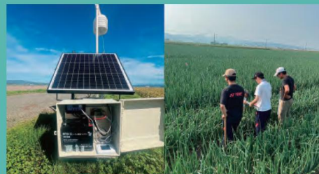
製作した水分量センサー(左)と、タマネギ畑での調査の様子(右)
