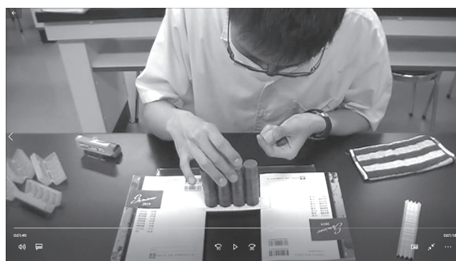
写真 実際のYou tubeでの配信動画と制作した紙の橋に10円玉を載せている様子 最高記録は300枚となった（10円玉が足りなかったため、上限が300枚となった）
