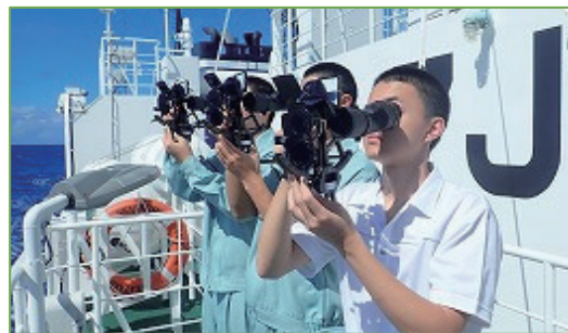
マグロ延縄漁業実習で、六分儀を使用し、正確な時間と太陽の高度から船の位置を算出しています。
